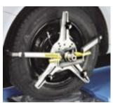
einheit (Best.-Nr. 932 401 111), Spannbereich bis 23" (optional bis 26"). **Optional:** Multi-quick-clamp (Best.-Nr. 932 401 111), clamping range up to 23"
