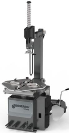
Quadratischer Spannteller mit automatischen Spannklaunen
