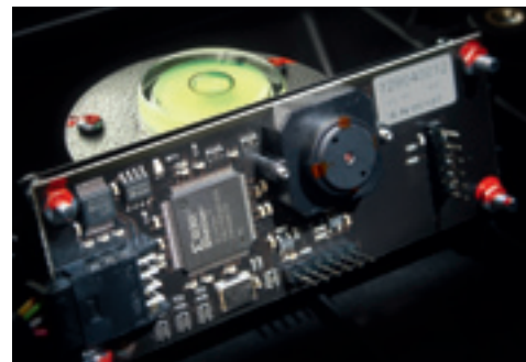
CMOS-Kamera mit hoher Auflösung und Bildrate
