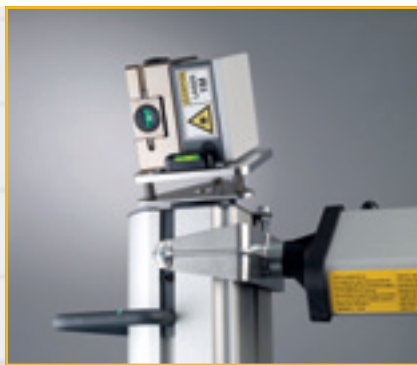
Das vertikale Laser-Modul am Kopf des MLD 815 Ford (Laserklasse M1)
